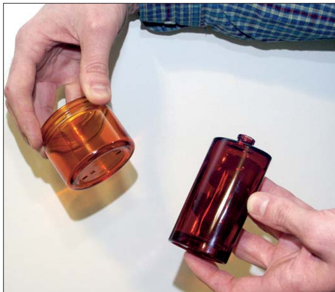
Die Glasflakons sind mit einem sehr Chemikalien-resistenten, silanmodifizierten Nanowassereinbrennlack beschichtet.
